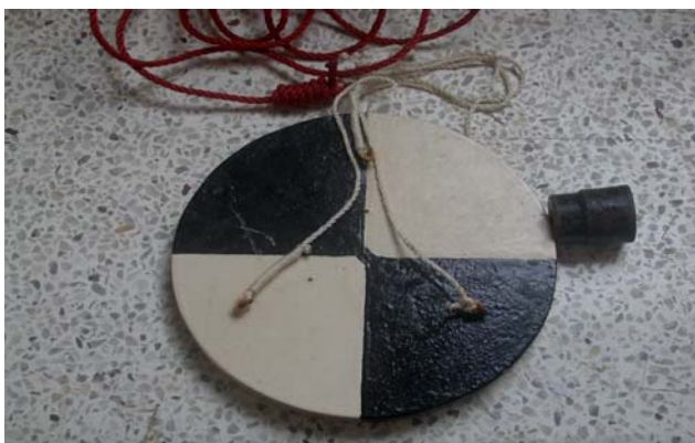
ภาพที่ 3 แผ่นวงกลมขาวดำ (Secchi disc)
