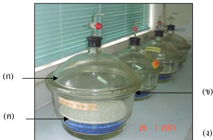
ภาพที่ 1.3 ลักษณะของเดซิกเคเตอร์ (ก) ฟลา (ข) ตัวเดซิกเคเตอร์ (ค) สารดูดความชื้น (ง) แผ่นกระเบื้อง
