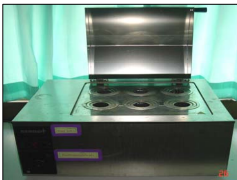
ภาพที่ 1.5 ลักษณะของอ่างน้ำควบคุมอุณหภูมิและปุ่มหมุนปรับอุณหภูมิของอ่างน้ำ
