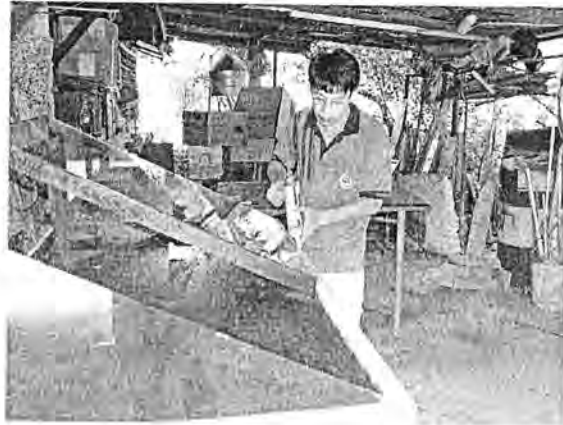
รูปที่ 7 การสร้างตู้อบแห้งพลังงานแสงอาทิตย์
