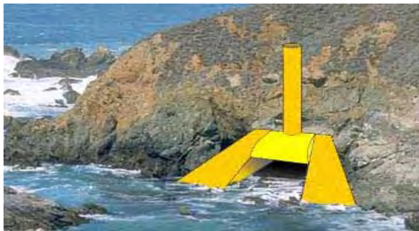
ภาพที่ 14.4. แสดงภาพการติดตั้งของ Oscillating Water Column
